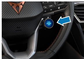
Deaktivace vysokonapěťového systému
