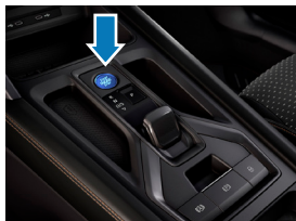
Deaktivace vysokonapěťového systému
