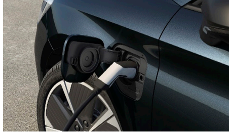
Toma de carga
