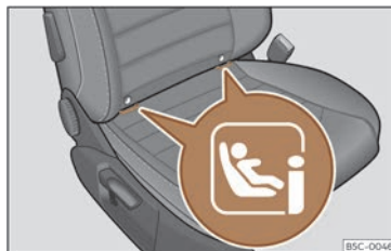
Abb. 39 Beifahrersitz: Einbauort der Halteösen i-Size.
