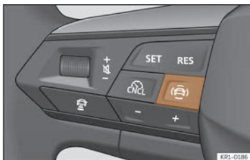
Abb. 111 Linke Seite des Multifunktionslenkrads: Taste für die Fahrerassistenzsysteme (modellabhängig).
