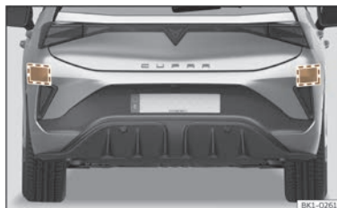
Abb. 115 Bereich hinter dem Fahrzeug: Bereiche der Radarsensoren.
