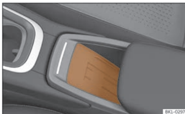
Abb. 164 In der Mittelkonsole: Aufnahme für die Mobiltelefonkopplung.
