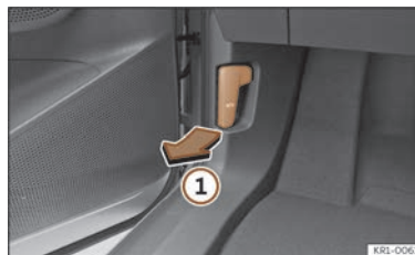
Abb. 199 Entriegelungshebel im Fahrerfußraum.
