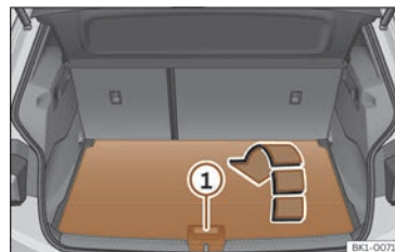
Abb. 171 Im Gepäckraum: Zweiten Gepäckraumboden öffnen.
