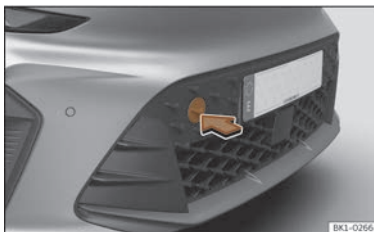
Abb. 193 Auf der rechten Seite des vorderen Stoßfängers: Abdeckung entfernen.
