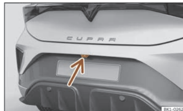
Abb. 117 Im Stoßfänger hinten: Einbauort der Kamera des Rückfahrassistenten.
