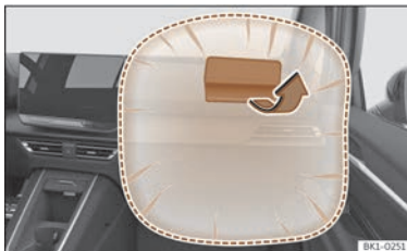
Abb. 27 Beifahrerairbag in der Schalttafel.
