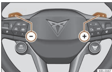
Abb. 107 Multifunktionslenkrad: Hebeln zur Energierückgewinnung.
