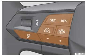
Abb. 122 Am Multifunktionslenkrad: Tasten zur ACC-Bedienung.
