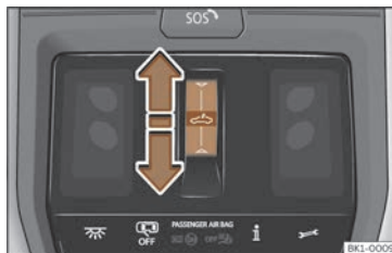
Abb. 103 Im Dachhimmel: Funktionsfläche zur Bedienung des Sonnenschutzrollos.
