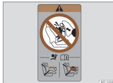
Abb. 37 Airbag-Label: am hinteren Rahmen der Beifahrertür.
