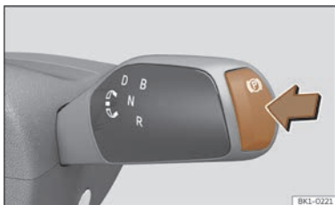
Abb. 138 Am Fahrstufenschalter: Taste der elektronischen Parkbremse.
