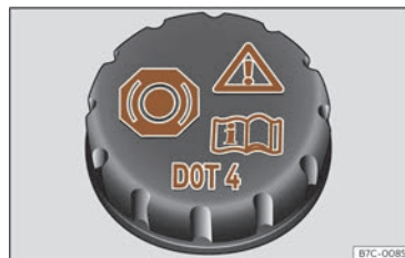
Abb. 203 Frontraum: Deckel des Bremsflüssigkeitsbehälters.
