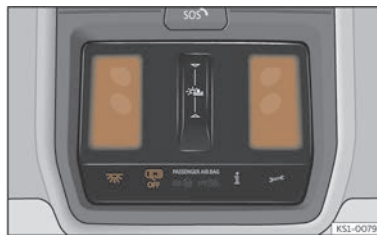
Abb. 97 Ausschnitt aus Dachhimmel: Innenraumbeleuchtung vorn.
