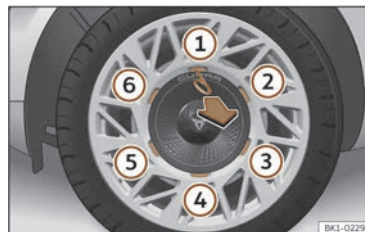
Abb. 208 Radwechsel: Radvollblende ausbauen
