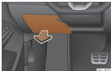
Abb. 195 Auf der Fahrerseite in der Schalttafel: Abdeckung des Sicherungskastens.
