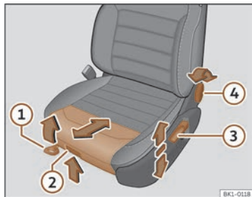
Abb. 86 Vordersitze: Manuelle Sitzverstellung.
