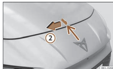
Abb. 200 Hebel unter der Motorraumklappe.
