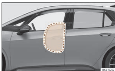
Abb. 33 Kompletzt aufgeblasener Seitenairbag auf der linken Fahrzeugseite.
