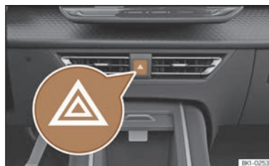
Abb. 47 Schalttafel: Schalter für die Warnblinkanlage
