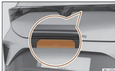
Abb. 80 Heckklappe: Öffnen von außen
