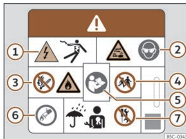
Abb. 53 Warnschild auf der Hochvoltbatterie.
