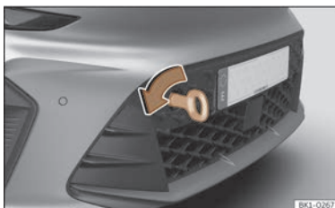
Abb. 194 Vorderer Stoßfänger rechts: eingeschraubte Abschleppöse
