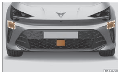
Abb. 112 Im vorderen Stoßfänger: Radarsensoren vorn und seitlich.
