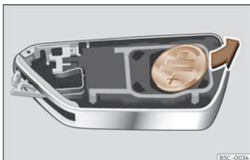
Abb. 71 Fahrzeugschlüssel: Batterie herausnehmen.
