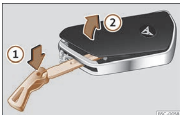
Abb. 70 Fahrzeugschlüssel: Abdeckung des Batteriefachs öffnen.
