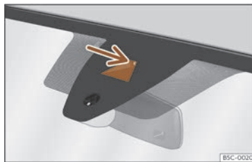
Abb. 114 An der Frontscheibe: Kamerasichtfenster des Spurhalteassistenten.
