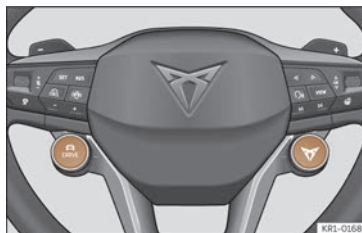
Abb. 110 Multifunktionslenkrad: Tasten DRIVE und CUPRA, um das Fahrprofil auszuwählen und zu wechseln.
