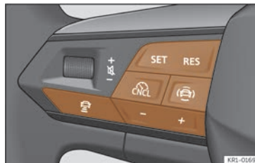
Abb. 132 Linke Seite des Multifunktionslenkrads.
