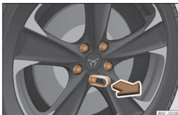
Abb. 209 Rad: Radschrauben mit Abdeckkappen.
