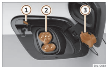
Abb. 59 Hinter der Batterieladeklappe hinten rechts: Ladedose.
