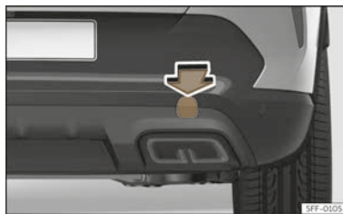
Abb. 225 Auf der rechten Seite des hinteren Stoßfängers: Abdeckung entfernen.
