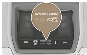
Abb. 29 In der Dachkonsole: Kontrollleuchte für abgeschalteten Beifahrerairbag.
