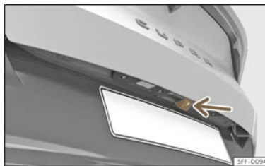
Abb. 136 Im Griff der Heckklappe: Einbauort der Kamera des Rückfahrassistenten.
