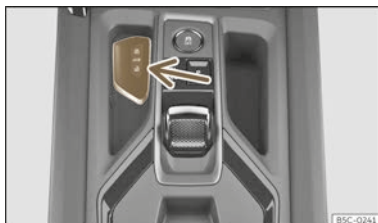
Abb. 72 Mittelkonsole (mit Automatikgetriebe): Aufnahme für den Fahrzeugschlüssel
