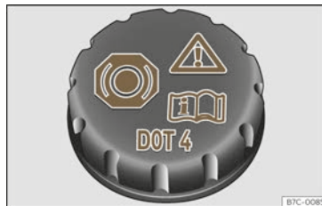
Abb. 236 Frontraum: Deckel des Bremsflüssigkeitsbehälters.
