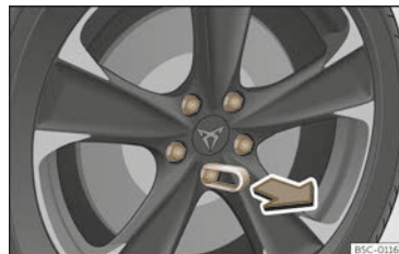
Abb. 251 Rad: Radschrauben mit Abdeckkappen.
