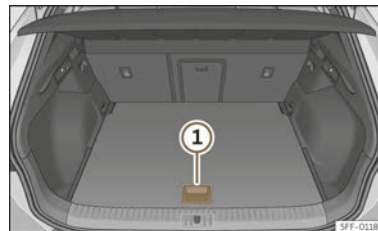
Abb. 194 Variabler Gepäckraumboden: hohe Position.
