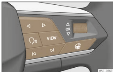
Abb. 10 Rechte Seite des Multifunktionslenkrads: Bedienelemente für die Menüs und Informationsanzeigen im Kombi-Instrument (modellabhängig).
