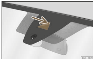
Abb. 133 An der Frontscheibe: Kamerasichtfenster des Spurhalteassistenten.
