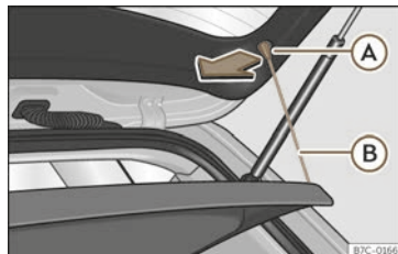
Abb. 190 Im Gepäckraum: Gepäckraumabdeckung aus- und einbauen.
