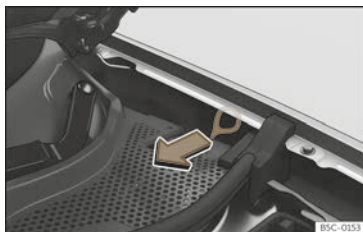
Abb. 66 Zwischen dem linken Kotflügel und dem Scharnier der Frontklappe: Ziehgriff für manuelle Notentriegelung des Ladesteckers.
