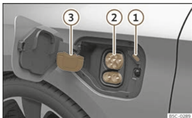
Abb. 63 Hinter der Batterieladeklappe hinten rechts: Ladedose.
