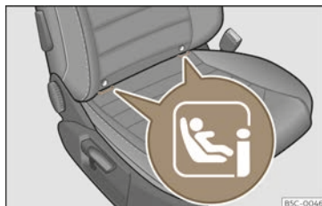
Abb. 41 Beifahrersitz: Einbauort der Halteösen i-Size.
