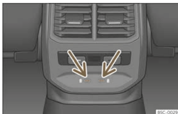
Abb. 183 Mittelkonsole hinten: USB-Anschlüsse mit Steckdosenfunktion.
