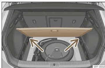
Abb. 196 Variabler Gepäckraumboden: geneigte Stellung.
