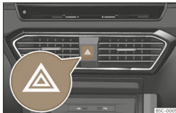
Abb. 50 Schalttafel: Schalter für die Warnblinkanlage
