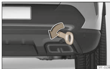
Abb. 226 Auf der rechten Seite des hinteren Stoßfängers: eingeschraubte Abschleppöse.
