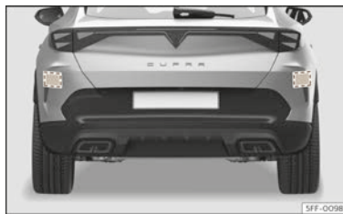
Abb. 134 Bereich hinter dem Fahrzeug: Bereiche der Radarsensoren.
