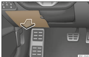
Abb. 227 Auf der Fahrerseite in der Schalttafel: Abdeckung des Sicherungskastens.
