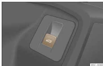
Abb. 84 An der Fahrertür: Taste zum Öffnen und Schließen der Heckklappe.
