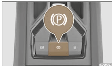
Abb. 156 Im unteren Bereich der Mittelkonsole: Taste für die elektronische Parkbremse.
