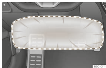
Abb. 36 Auf der Fahrerseite: Wirkungsbereich des Knieairbags.
