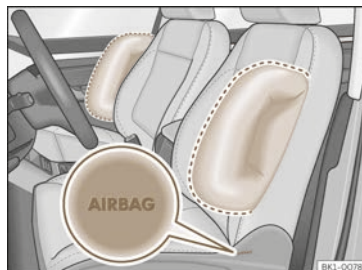
Abb. 32 Seitenairbag im Fahrer- und Beifahrersitz.
