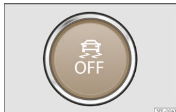
Abb. 129 Im unteren Bereich der Mittelkonsole: Taste zum Ein-/Ausschalten von ESC (je nach Version).
