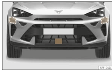
Abb. 131 Im vorderen Stoßfänger: Radarsensoren vorn und seitlich.
