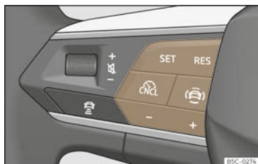
Abb. 138 Am Multifunktionslenkrad: Tasten zur Bedienung des Geschwindigkeitsbegrenzers.
