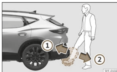
Abb. 86 Heckklappe mit bewegungssensorgesteuerter Öffnung (Easy Open).
