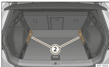
Abb. 195 Variabler Gepäckraumboden: niedrige Position.
