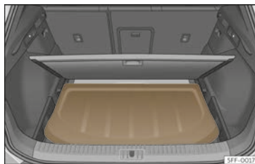
Abb. 193 Im Gepäckraum: Einsetzen der Gepäckraumabdeckung.
