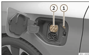
Abb. 60 Hinter der Batterieladeklappe vorn links: Ladedose
