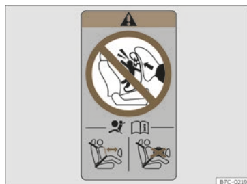
Abb. 39 Airbag-Label: am hinteren Rahmen der Beifahrertür.
