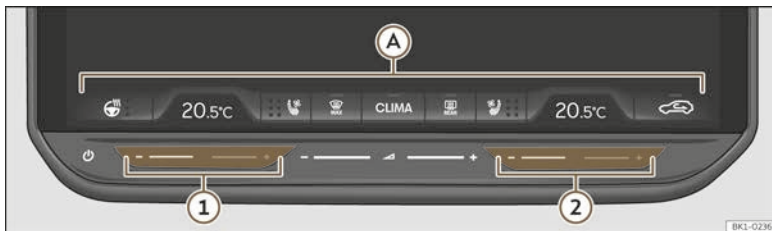
Abb. 116 Schematische Darstellung: Klimatisierungsfunktionen.
