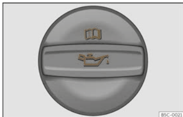
Abb. 250 Deckel der Motoröl-Einfüllöffnung im Motorraum.
