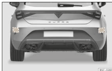
Abb. 134 Bereich hinter dem Fahrzeug: Bereiche der Radarsensoren.
