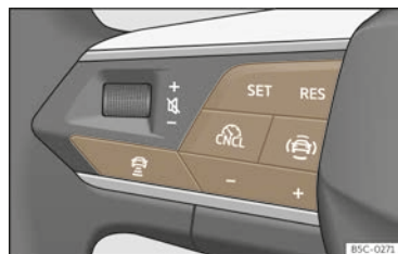
Abb. 141 Am Multifunktionslenkrad: Tasten zur ACC-Bedienung.
