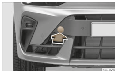
Abb. 229 Auf der rechten Seite des vorderen Stoßfängers: Abdeckung entfernen.
