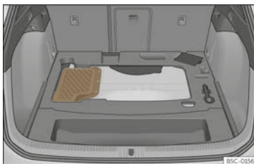
Abb. 251 Plug-in-Hybridfahrzeuge (PHEV): Einbauort der Batterie im Gepäckraum.
