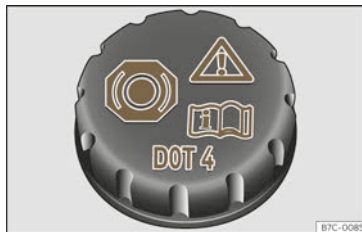
Abb. 244 Frontraum: Deckel des Bremsflüssigkeitsbehälters.
