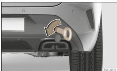
Abb. 233 Leon Sportstourer. Auf der rechten Seite des hinteren Stoßfängers: eingeschraubte Abschleppöse.
