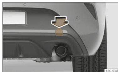
Abb. 232 Leon. Auf der rechten Seite des hinteren Stoßfängers: Abdeckung entfernen.
