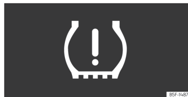
Abb. 264 Kombi-Instrument: Warnung Reifendruckverlust.
