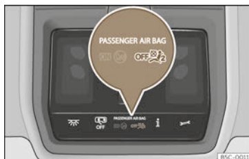
Abb. 29 In der Dachkonsole: Kontrollleuchte für abgeschalteten Beifahrerairbag.
