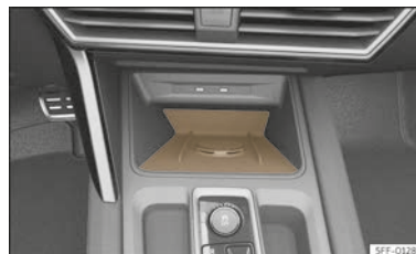
Abb. 185 In der Mittelkonsole: Aufnahme für die Mobiltelefonkopplung.
