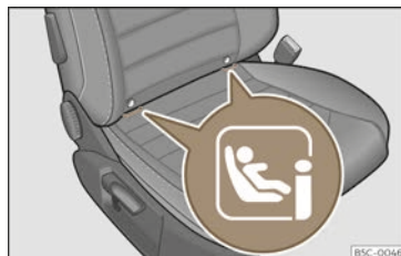
Abb. 41 Beifahrersitz: Einbauort der Halteösen i-Size.
