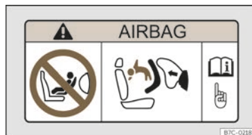
Abb. 38 Airbag-Label: an der Sonnenblende Beifahrerseite.
