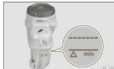
Abb. 243 Im Motorraum: Kühlmittelausgleichsbehälter.
