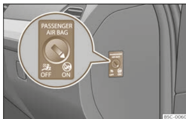
Abb. 28 Schlüsselschalter zum Ein- und Abschalten des Beifahrerairbags.
