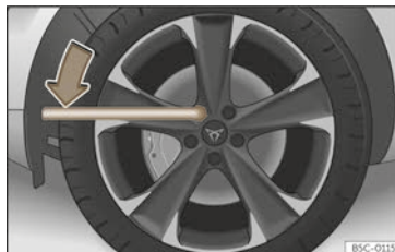
Abb. 261 Radwechsel: Radschrauben lockern.
