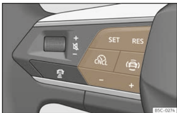
Abb. 137 Am Multifunktionslenkrad: Tasten zur Bedienung der Geschwindigkeitsregelanlage.
