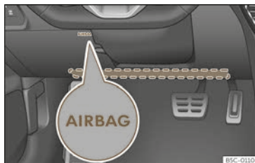
Abb. 35 Auf der Fahrerseite: Einbauort des Knieairbags.
