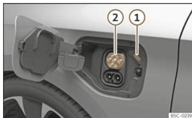
Abb. 60 Hinter der Batterieladeklappe vorn links: Ladedose
