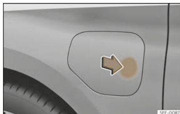
Abb. 59 Öffnung der Batterieladeklappe.
