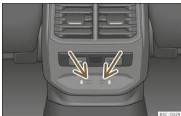
Abb. 179 Mittelkonsole hinten: USB-Anschlüsse mit Steckdosenfunktion.
