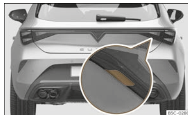
Abb. 82 Heckklappe: Öffnen von außen
