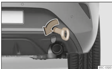
Abb. 234 Leon. Auf der rechten Seite des hinteren Stoßfängers: eingeschraubte Abschleppöse.
