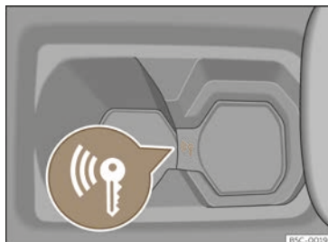
Abb. 122 In der Mittelkonsole: Notstart.
