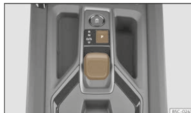
Abb. 126 In der Mittelkonsole: Wahlschalter
