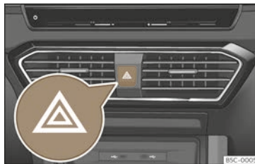
Abb. 50 Schalttafel: Schalter für die Warnblinkanlage
