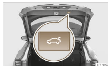
Abb. 84 Heckklappe: Taste zum Schließen der Heckklappe.
