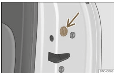
Abb. 80 Notverriegelung der Tür.
