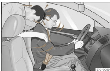
Abb. 21 Der nicht angegurte Mitfahrer auf dem Rücksitz wird nach vorn auf den angegurten Fahrer geschleudert.
