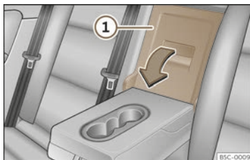
Abb. 207 An der Rücksitzlehne: Öffnung der Durchladeeinrichtung.
