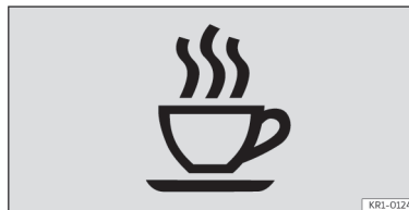
Abb. 7 Am Bildschirm des Kombi-Instruments: Symbol des Müdigkeitsmonitors.
