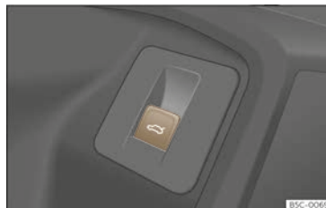
Abb. 83 An der Fahrertür: Taste zum Öffnen und Schließen der Heckklappe.
