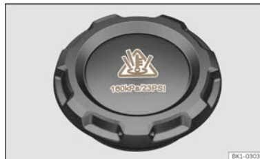
Abb. 241 Motorraum: Deckel des Motorkühlmittelausgleichsbehälters
