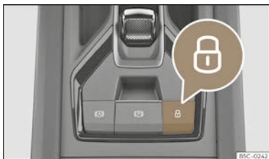
Abb. 78 Auf der Mittelkonsole: Zentralverriegelungstaster
