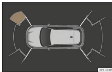
Abb. 147 Im Infotainment-System: Anzeige des Kreuzfahrassistenten.
