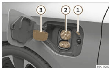
Abb. 62 Hinter der Batterieladeklappe hinten rechts: Ladedose.
