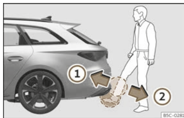
Abb. 85 Heckklappe mit sensorgesteuerter Öffnung (Easy Open).
