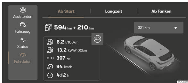
Abb. 14 Schematische Darstellung: Information und Fahrzeugstatus.
