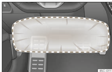
Abb. 36 Auf der Fahrerseite: Wirkungsbereich des Knieairbags.
