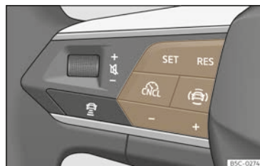
Abb. 138 Am Multifunktionslenkrad: Tasten zur Bedienung des Geschwindigkeitsbegrenzers.
