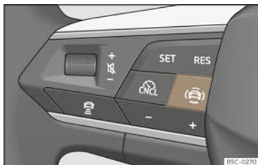
Abb. 130 Linke Seite des Multifunktionslenkads: Taste für die Fahrerassistenzsysteme (modellabhängig).
