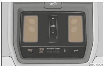
Abb. 109 Ausschnitt aus Dachhimmel: Innenraumbeleuchtung vorn.
