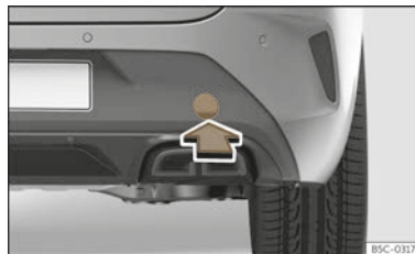
Abb. 231 Leon Sporttourer. Auf der rechten Seite des hinteren Stoßfängers: Abdeckung entfernen.
