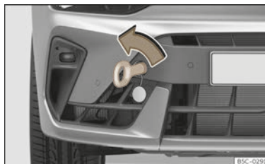
Abb. 230 Vorderer Stoßfänger rechts: eingeschraubte Abschleppöse
