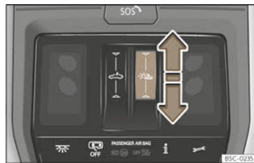
Abb. 91 Im Dachhimmel: Sonnenschutzrollo bedienen.
