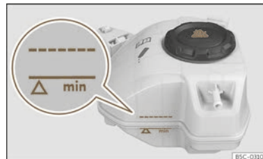
Abb. 242 Im Motorraum: Kühlmittelausgleichsbehälter.
