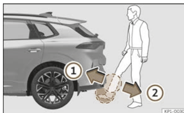
Abb. 85 Heckklappe mit bewegungssensorgesteuerter Öffnung (Easy Open).
