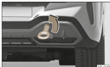
Abb. 219 Auf der rechten Seite des hinteren Stoßfängers: eingeschraubte Abschleppöse.
