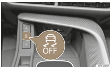
Abb. 122 Im unteren Bereich der Mittelkonsole: Taste zum Ein-/Ausschalten von ESC.
