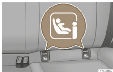
Abb. 40 Rückbank: Einbauort der Halteösen ISOFIX oder i-Size.
