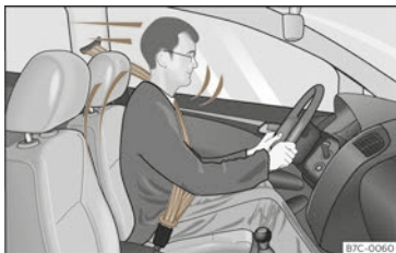
Abb. 19 Richtig angegurtete Fahrer werden bei einem plötzlichen Bremsmanöver nicht nach vorne geschleudert.
