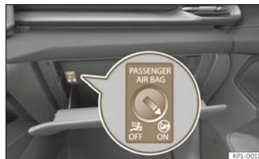
Abb. 30 Schüsselschalter zum Ein- und Abschalten des Beifahrerairbags.
