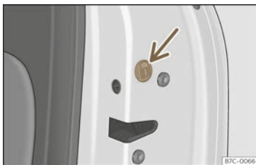
Abb. 80 Notverriegelung der Tür.
