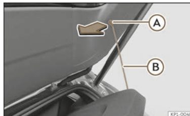
Abb. 184 Im Gepäckraum: Gepäckraumabdeckung aus- und einbauen.
