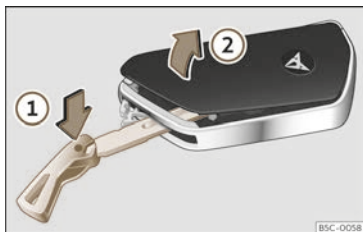
Abb. 72 Fahrzeugschlüssel: Abdeckung des Batteriefachs öffnen.
