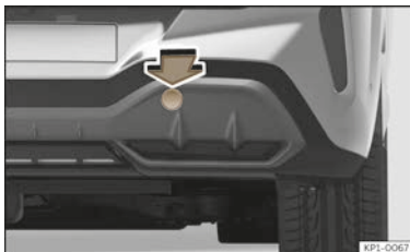
Abb. 218 Auf der rechten Seite des hinteren Stoßfängers: Abdeckung entfernen.
