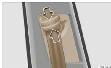
Abb. 27 Bei den Vordersitzen: Gurthöheneinstellung.
