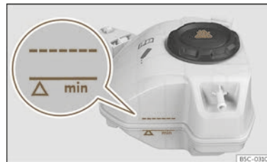
Abb. 228 Im Motorraum: Kühlmittelausgleichsbehälter.
