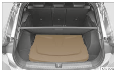
Abb. 187 Im Gepäckraum: Einsetzen der Gepäckraumabdeckung.
