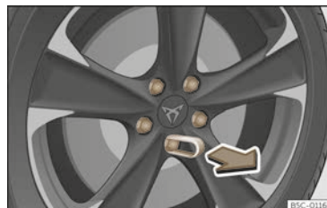
Abb. 245 Rad: Radschrauben mit Abdeckkappen.
