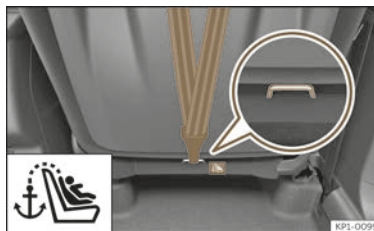
Abb. 44 Rückseite der Beifahrersitzlehne: Verankerung für den Top Tether Haltegurt (nicht in allen Märkten/Versionen erhältlich).
