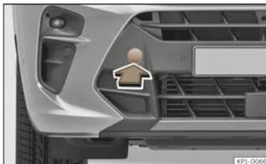
Abb. 216 Auf der rechten Seite des vorderen Stoßfängers: Abdeckung entfernen.
