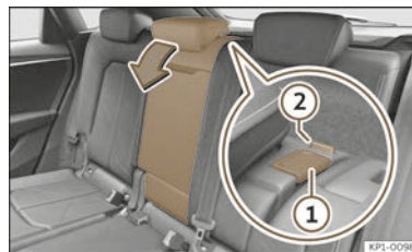
Abb. 196 Rücksitzlehne: Öffnung der Durchladeeinrichtung.
