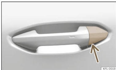
Abb. 78 Fahrertürgriff: verborgener Schließzylinder.
