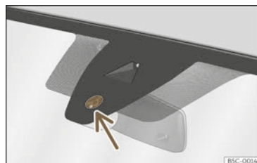
Abb. 107 Sensitive Fläche des Regensensors.
