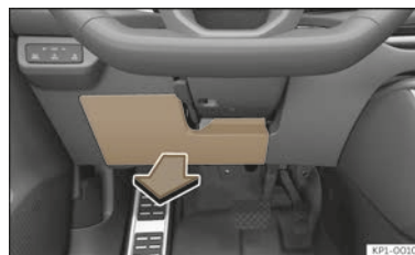
Abb. 220 Auf der Fahrerseite in der Schalttafel: Abdeckung des Sicherungskastens.
