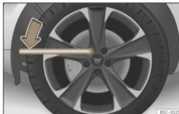
Abb. 247 Radwechsel: Radschrauben lockern.
