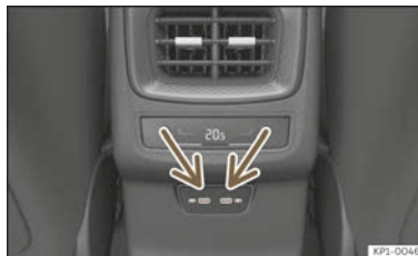
Abb. 177 Mittelkonsole hinten: USB-Anschlüsse mit Steckdosenfunktion.
