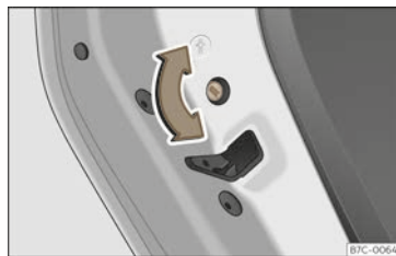
Abb. 81 Kindersicherung in der linken Tür
