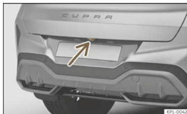
Abb. 129 Im Griff der Heckklappe: Einbauort der Kamera des Rückfahrassistenten.
