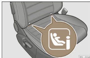
Abb. 41 Beifahrersitz: Einbauort der Halteösen i-Size.
