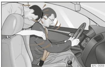
Abb. 22 Der nicht angegurtete Mitfahrer auf dem Rücksitz wird nach vorn auf den angegurteten Fahrer geschleudert.
