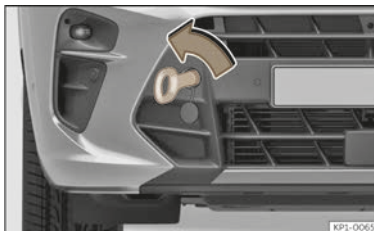
Abb. 217 Vorderer Stoßfänger rechts: eingeschraubte Abschleppöse
