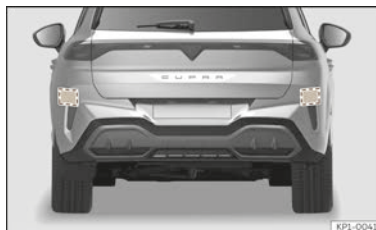
Abb. 127 Bereich hinter dem Fahrzeug: Bereiche der Radarsensoren.
