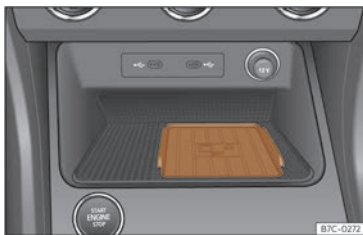
Fig. 160 En la consola central: alojamiento para la conexión del teléfono móvil.
