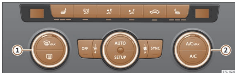
Fig. 85 En la consola central: mandos del Climatronic.
