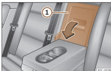
Fig. 172 En el respaldo del asiento trasero: apertura de la trampilla.
