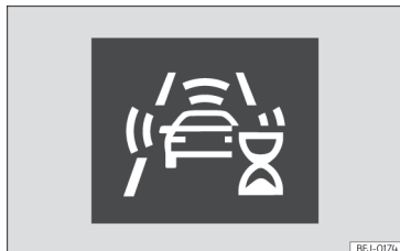
Fig. 117 En la pantalla del cuadro de instrumentos: indicación de autocalibración inicial del sistema.
