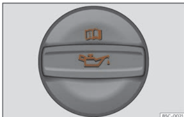
Fig. 206 Tapa de la boca de llenado de aceite del motor en el vano motor.
