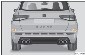
Fig. 103 Vista trasera del vehículo: zonas de los sensores de radar.
