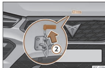
Fig. 198 Palanca bajo el capó.
