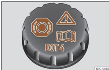
Fig. 201 Vano delantero: tapón del depósito del líquido de frenos.
