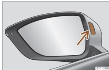
Fig. 122 Testigo de control del asistente de cambio de carril.
