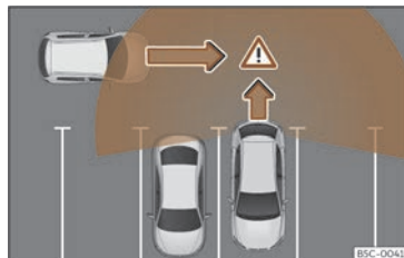
Fig. 146 Representación esquemática del asistente de desaparcamiento: zona vigilada alrededor del vehículo que está desaparcando.
