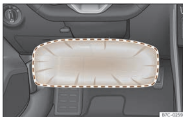
Fig. 30 En el lado del conductor: radio de acción del airbag para las rodillas.
