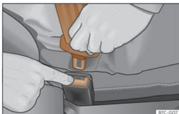
Fig. 19 Soltar la lengüeta del cierre del cinturón.
