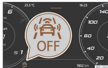
Fig. 118 En la pantalla del cuadro de instrumentos: indicación de Front Assist desactivado.
