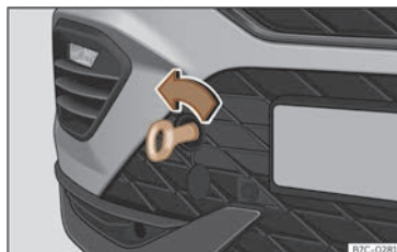
Fig. 190 Parte derecha del paragolpes delantero: argolla de remolque enroscada.
