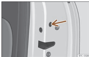
Fig. 51 Bloqueo de emergencia de la puerta.
