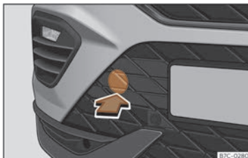
Fig. 189 En el lado derecho del paragolpes delantero: retirar la tapa.
