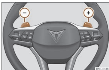
Fig. 93 Volante: palancas para cambio automático.
