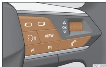
Fig. 7 Lado derecho del volante multifunción: teclas para utilizar los menús y las indicaciones informativas del cuadro de instrumentos (según versiones).
