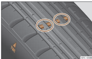
Fig. 209 Perfil del neumático: indicadores de desgaste.
