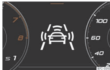
Fig. 116 En la pantalla del cuadro de instrumentos: indicaciones de preaviso.
