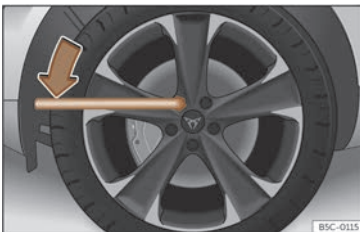
Fig. 215 Cambio de rueda: aflojar los tornillos de rueda.
