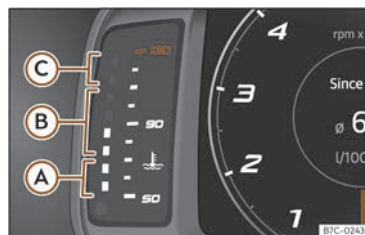
Fig. 3 Indicador de temperatura del líquido refrigerante del motor.
