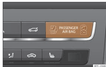
Fig. 25 Tablero de instrumentos: testigo de control de la desactivación del airbag del acompañante.
