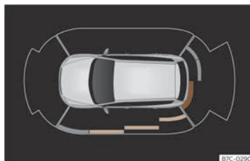
Fig. 131 Visualización de ayuda al aparcamiento en la pantalla del sistema de infotainment.
