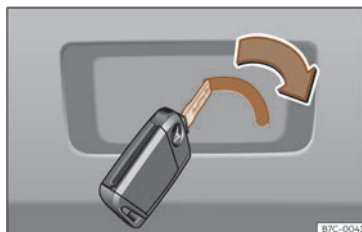
Fig. 58 Detalle del maletero: desbloqueo de emergencia.
